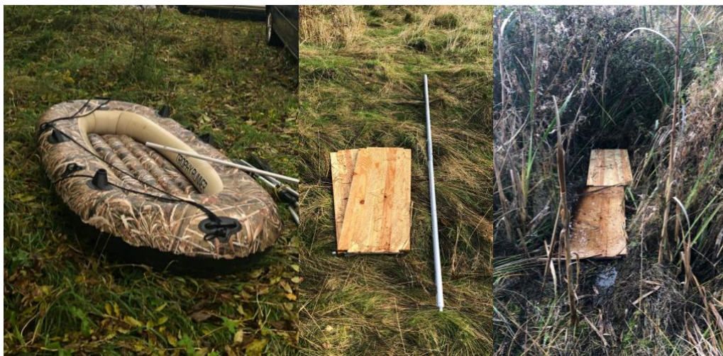
Figur 5. Fältarbets utrustning. Från vänster: uppblåsbar båt, plankor och mätpinne samt ett exempel på hur plankorna användes under fältarbetet.
