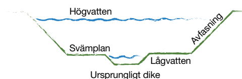
Tvästegsdiket är utformat med svämplan och avfasade kanter. Ofta anläggs tvästegsdiket genom en omgrävning av ett befintligt dike. Tvästegsdiket fördröjer och renar vattnet och är till stor nytta för naturmiljön.
