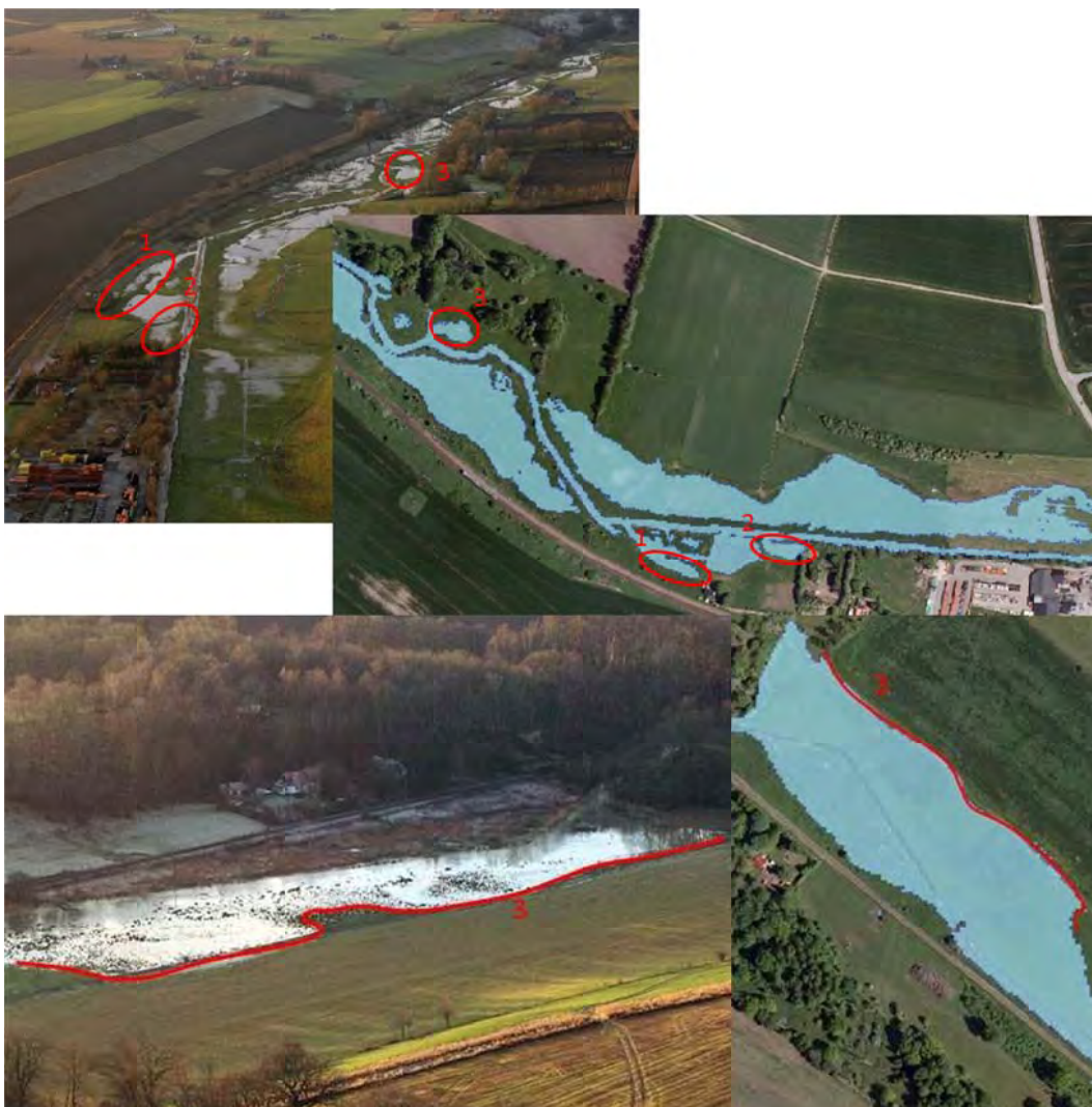
Figur 5.2 Jämförelse mellan simulerad översvämning och faktisk översvämning vid en vårflood i mars 2007. Punkt 1) formen och storleken på översvämningsytan stämmer överens. 2) Kanalen mellan översvämningsyta och åfåra är representerad i modellen. 3) Översvämningsytan har samma form och sträcker sig fram till grusvägen i både verkligheten och modellen.
